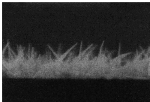
Figure I. 12 [67] : Images SEM du GaAsN cru sur le silicium Si(111) par la technique MS à T=470 \text{ }^{\circ}\text{C} et la vitesse 0.4 ML/s.
