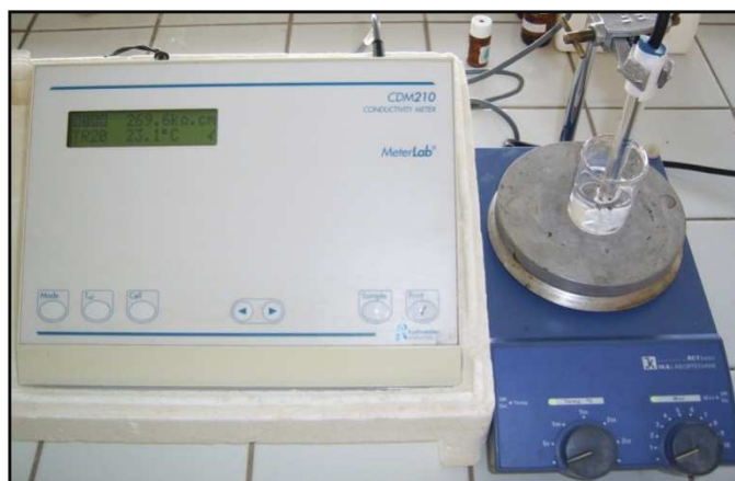
Figure 6: Conductimètre utilisé avec sa cellule électrolytique
