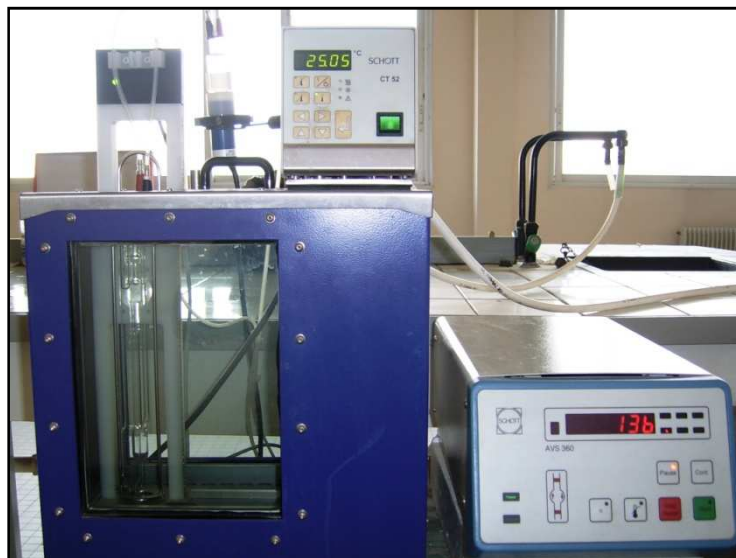
Figure 2: Viscosimètre à capillaire utilisé type Ubbelohde
