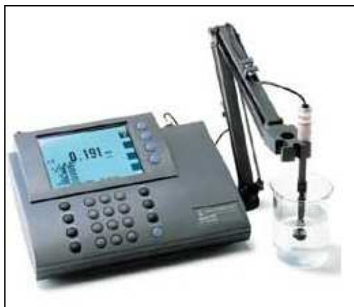
Figure 4 : pH-mètre Denver Instruments Model 225
