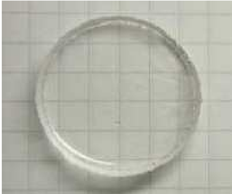
Figure II.4 : Un réseau de polyABu réticulé à 0.5% de HDDA après l'étape de polymérisation.
