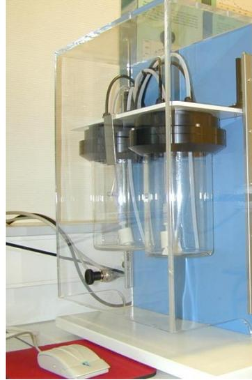
Photographies du zétamètre utilisé.
