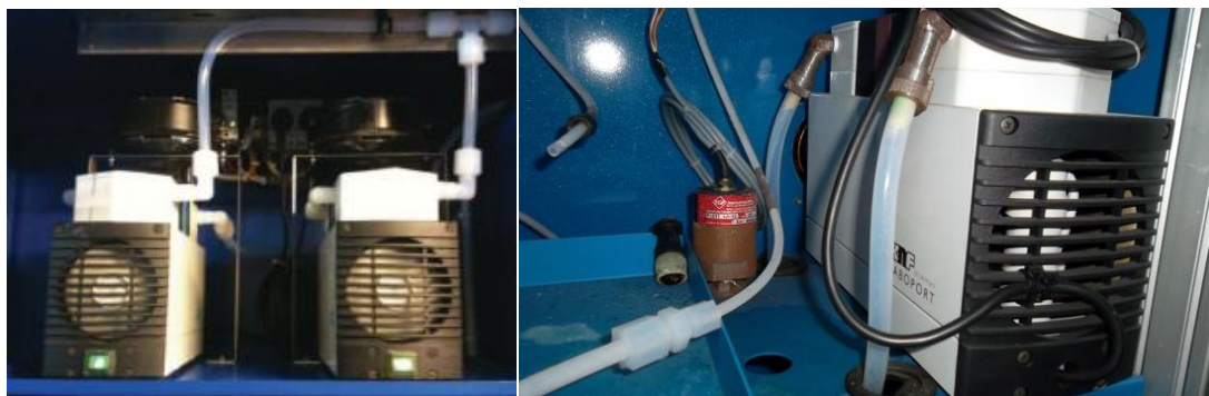
Figure III.2. : Système de pompage du four Lydop phosphore IRYSOLAR et IM2NP (droite)
