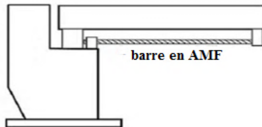
Figure 2.15 : Schéma d'installation de barre en AMF comme actionneur dans un pont.
