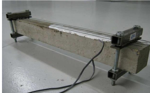
Figure 3.11 : Vue d'une poutre en béton équipée de quatre fils en AMF.
