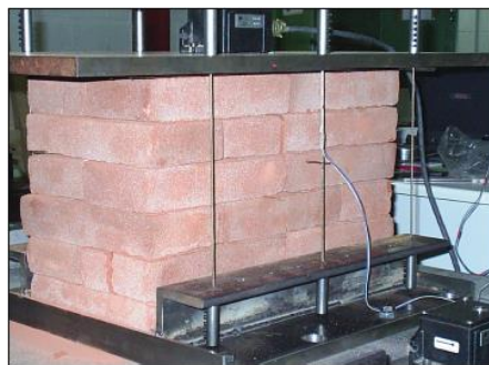
Figure 3.5 : Dispositif en AMF utilisé pour appliquer la précontrainte.
