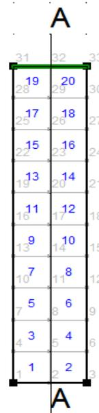
Figure 4.4 : Définition de l'axe AA (Numéro des nœuds 2, 5, 8, 11, 14, 17, 20, 23, 26 29 et 32).
