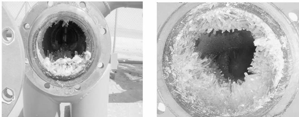
Figure I.7 Corrosion sous l'effet sels minéraux (installation pétrolière).
