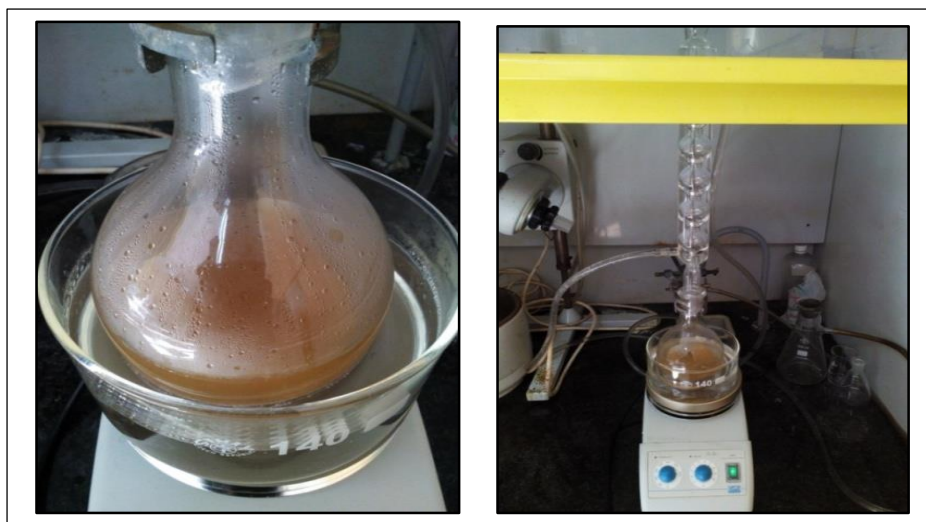
Figure n°43 : Extraction à reflux de la poudre d' Atractylis gummifera L. sous la hotte.
