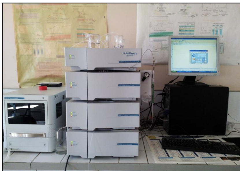
Figure n°49 : Appareil HPLC (YL9100 HPLC system).
