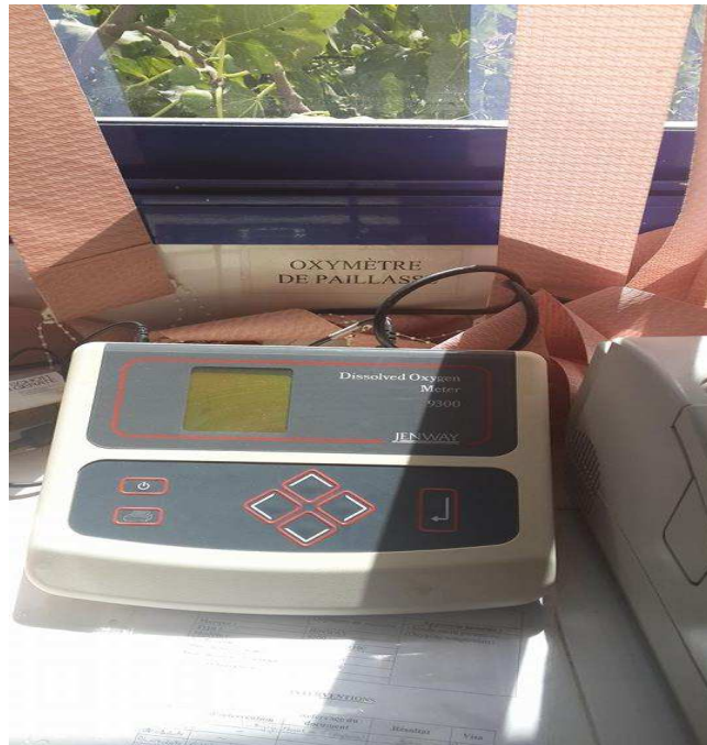
Photo III -3 : un oxymètre de pailleasse (TALEB.I, AHMED BRAHIM.D, photos prises au site, STEP de sidi bel abbes, 2014).
