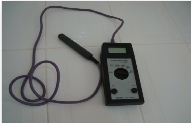
Photo III-5 : Salinimètre portatif (TALEB.I, AHMED BRAHIM.D, photos prises au site, STEP de sidi bel abbes, 2014).
