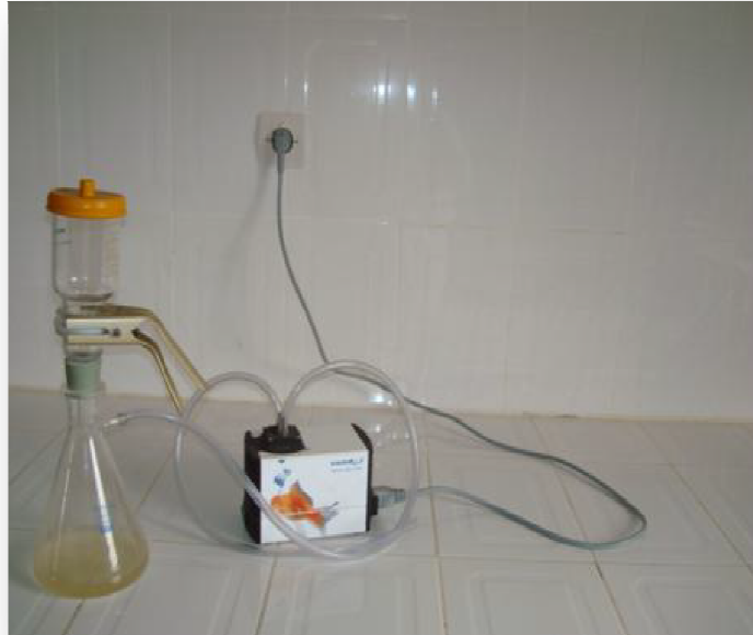
Photo III-6 : Appareil de filtration sous vide (TALEB.I., AIIMED BRAIIIM.D, photos prises au site, STEP de sidi bel abbes, 2014).
