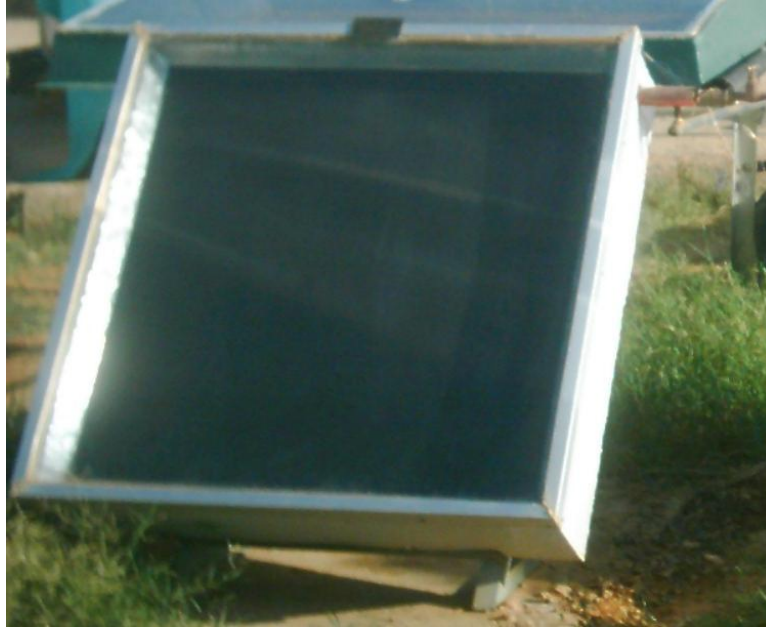
Figure IV-1: Photo du prototype de chauffe-eau solaire capteur-stockeur réalisé à l'URER/MS [25]
