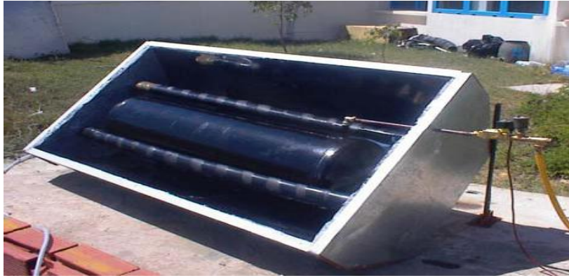
Figure III-13 : Vue du capteur-stockeur à réflecteur cylindro-parabolique réalisé en Tunisie [24].
