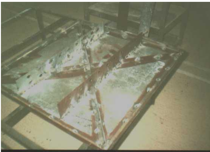
Figure IV-3: Photo des ailettes trouées installées à l'intérieur du capteur-stockeur
