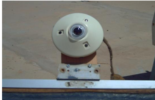
Figure IV-13: Le pyranomètre fixé sur le plan de la surface d'ouverture du capteur-stockeur
