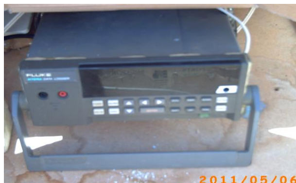
Figure IV-14: L'acquisition de données utilisée pour la lecture et le stockage des paramètres mesurés
