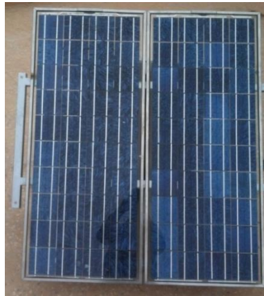
Figure IV. 11 Kit à base de deux modules solaires de type AEG PQ10/40/01
