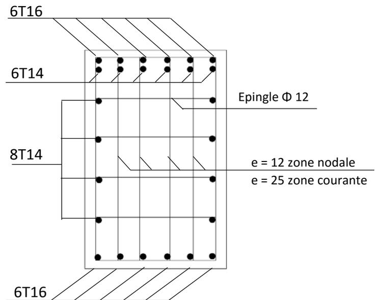
Figure 6.7 Ferrailage en appui de la nervure
