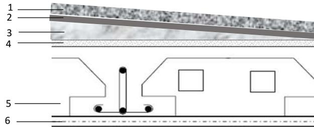
Figure 2.9 Elément constituant le plancher terrasse inaccessible
