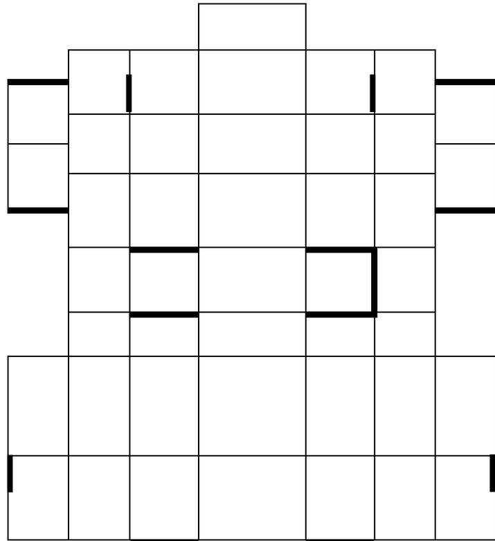
Figure 4.2 1<sup>ère</sup> disposition des voiles
