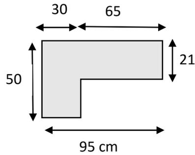
Figure 2.4 Poutre en L "1"
