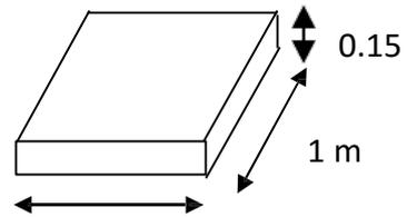
Figure 3.4 Schéma statique de la dalle pleine
