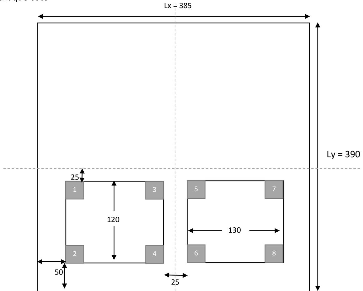
Figure 3.14 Surface des moteurs sur la dalle
