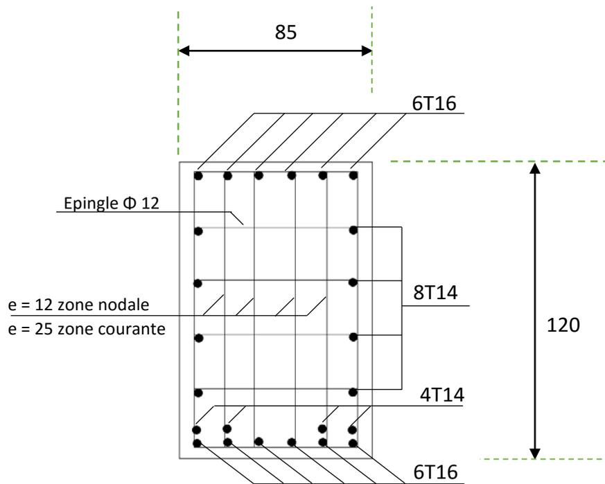
Figure 6.6 Ferrailage en travée de la nervure
