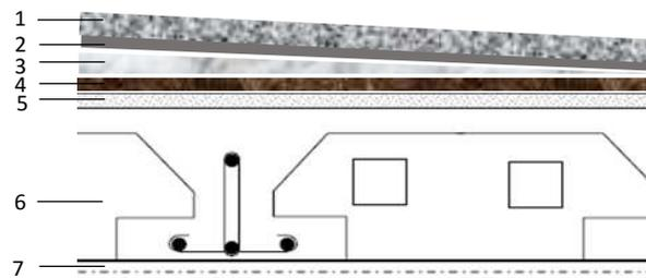
Figure 2.8 Eléments constituant le plancher terrasse accessible
