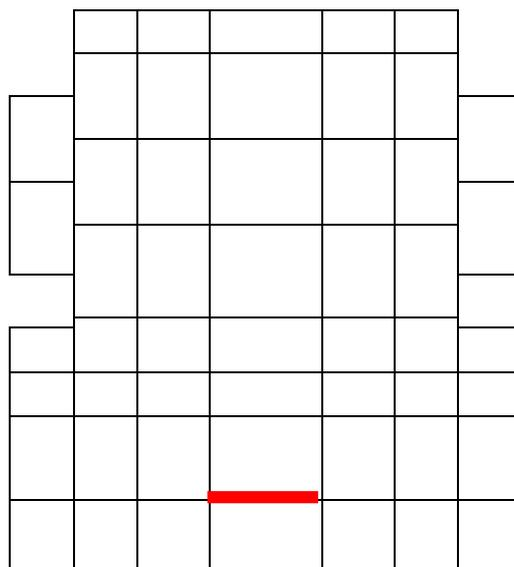
Figure 5.4 Emplacement de la poutre
