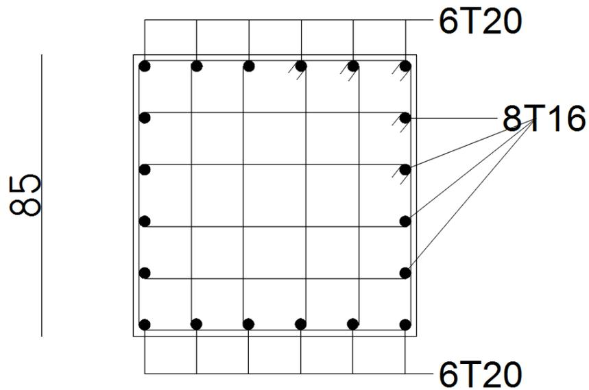
Figure 5.1 Ferrailage du poteau sous-sols 2 (85x85)
