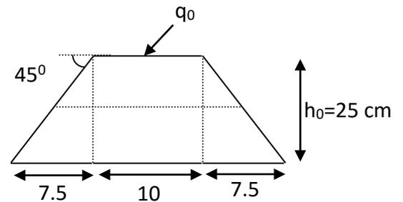
Figure 3.13 la dalle pleine sous un appui
