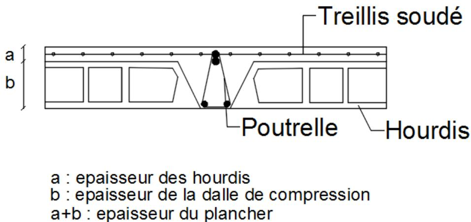
Figure 3.1 Eléments constituant un plancher corps creux
