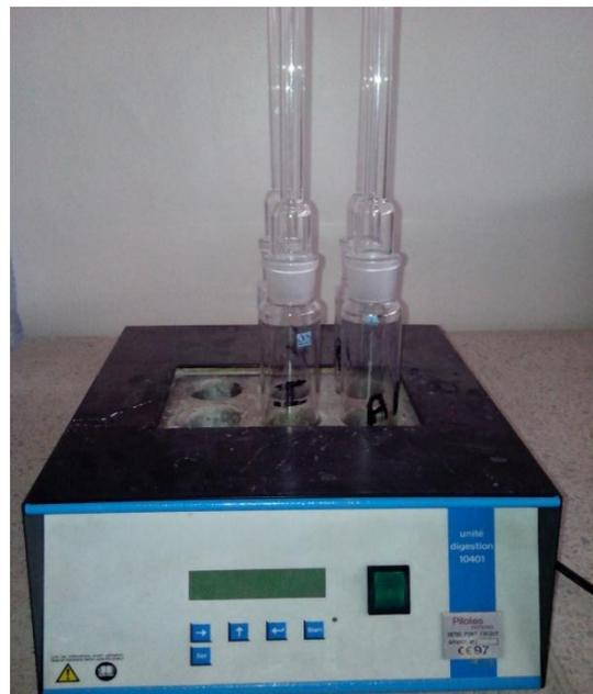
**Photo IV.6 :** Appareil de mesure de la DCO
