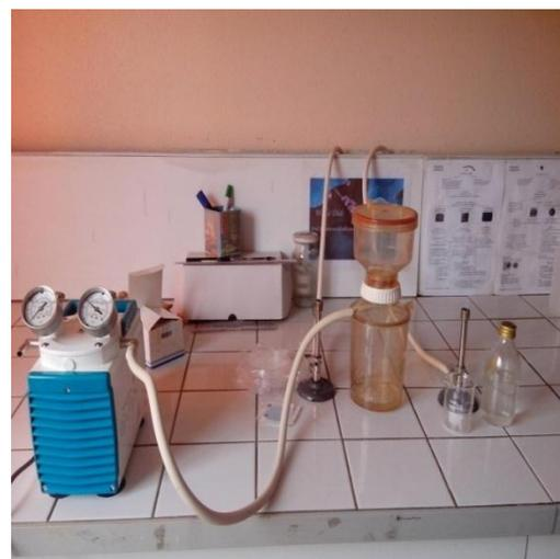
**Photo IV.9 :** Appareil de filtration sur membrane
