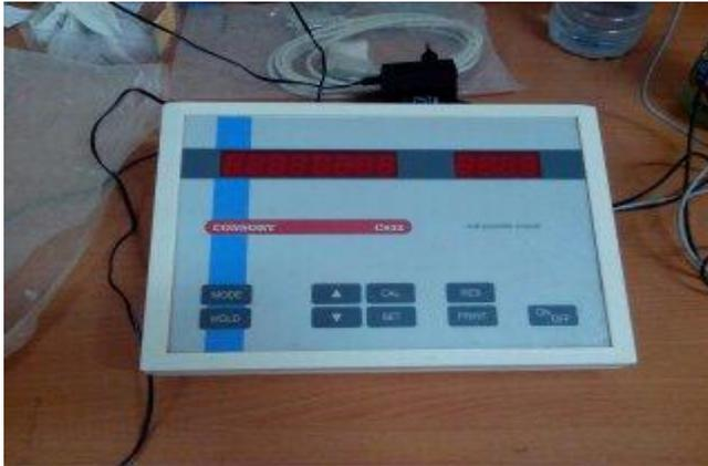
**Photo IV.7:** Appareil qui mesure la conductivité, la température et le pH
