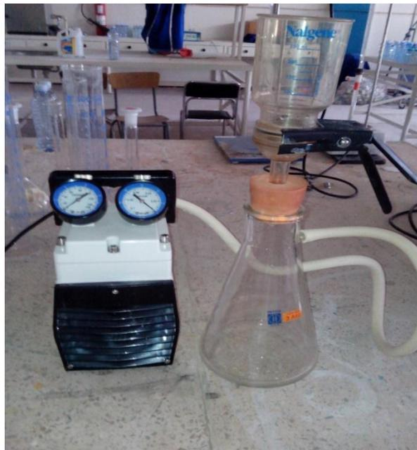
**Photo IV.4:** Dispositif de filtration sous vide
