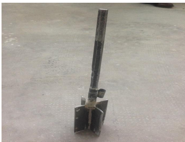
Figure 3.4. Illustration de la pale et du récipient du rhéomètre.
