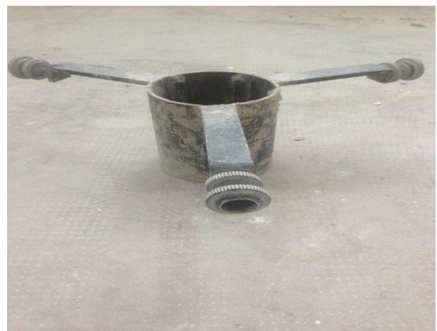
Figure 3.4. Illustration de la pale et du récipient du rhéomètre.
