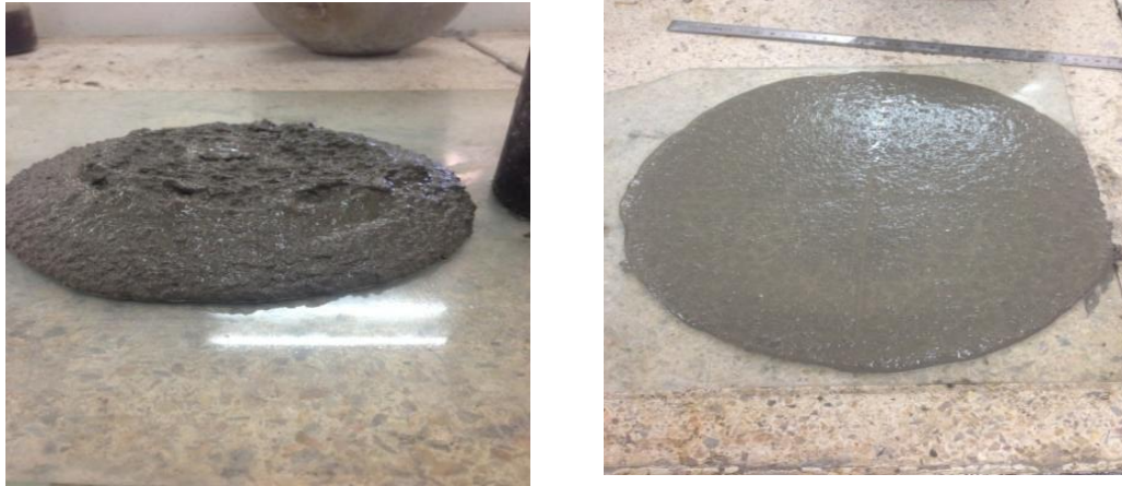
Figure 4.2 : Etalement des mortiers avec filler
