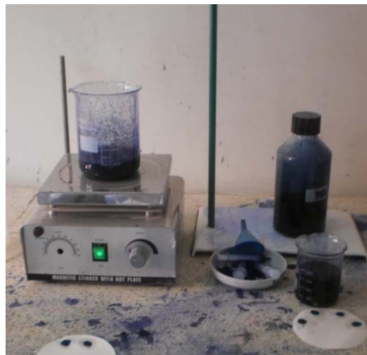
Figure 3.12 : Réalisation de l’essai au Bleu de Méthylène.
