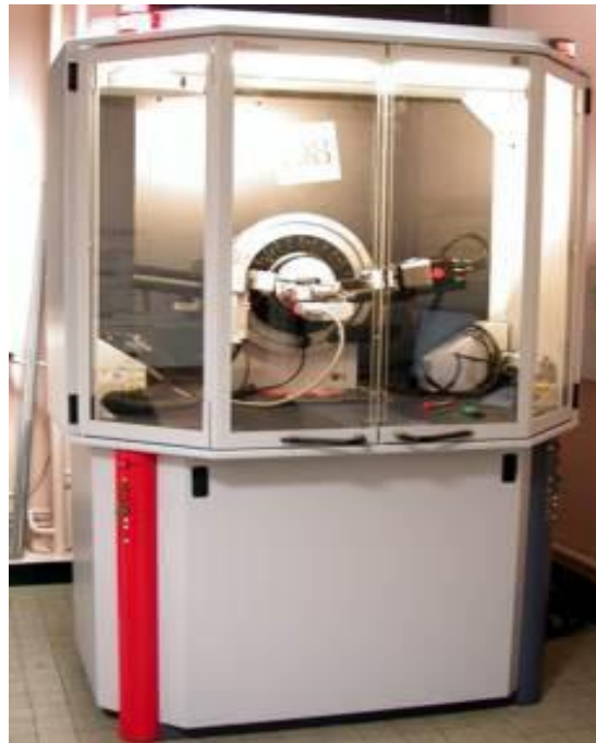
Figure III-2 : Diffractomètre Bruker D8Advanced utilisé dans un laboratoire à l'université de Lyon [40].
