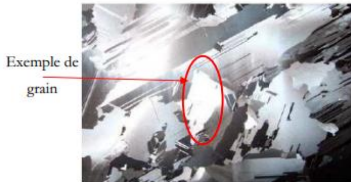
Figure I-4 : Photo d'un substrat de silicium polycristallin (échelle : 10 \times 10 \text{ cm}^2 ) [9].
