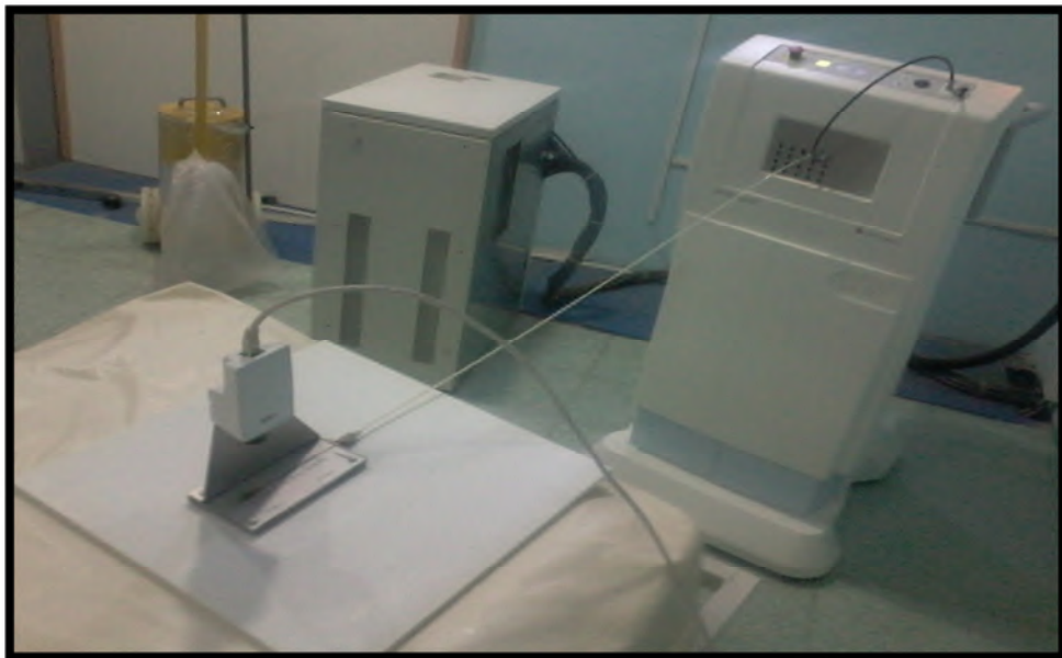
Figure III.9 : Vérification de positionnement et déplacement de la source fictive avec un camera.
