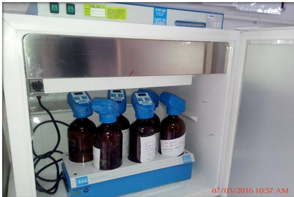
Figure IV.6: Photo du D.B.O mètre (VELP SCIENTIFICA)
