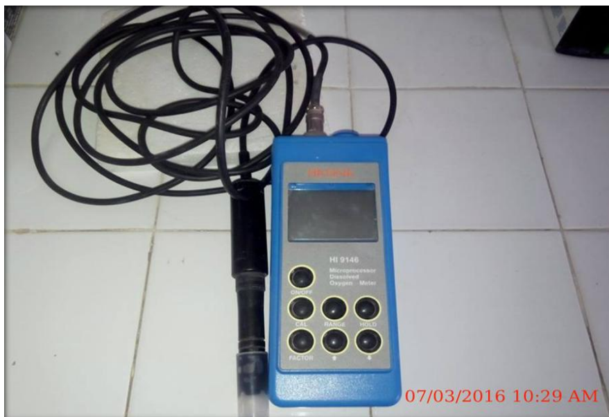
Figure IV.2: Photo de l'oxymètre (HANNA-HI 9146)
