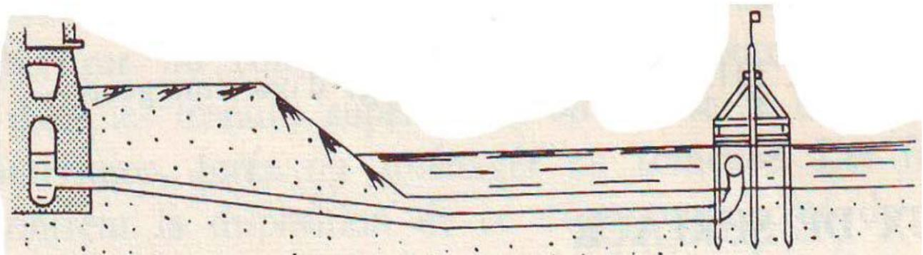
Figure I.2 : Prise au milieu d'une rivière (Bonnin, 1982).
