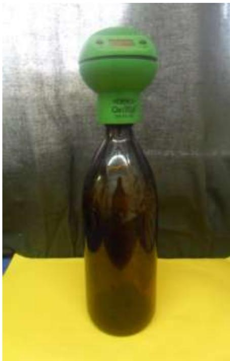
Figure V.3 : Photo d'un flacon à DBO
