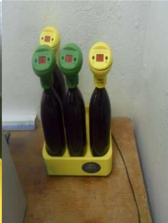
Figure V.4 : Photo du DBO mètre.
