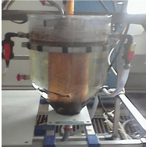
Figure III.5. Clarificateur (laboratoire du département d'hydraulique)
