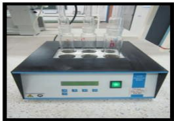
Figure III.16. Réacteur DCO (laboratoire du département d'hydraulique université de Tlemcen).
