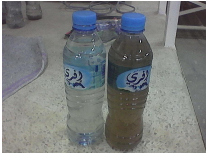
Figure IV.2. Eau à l'entrée du lit bactérien au garnissage de brique rouge et la sortie du décanteur.
