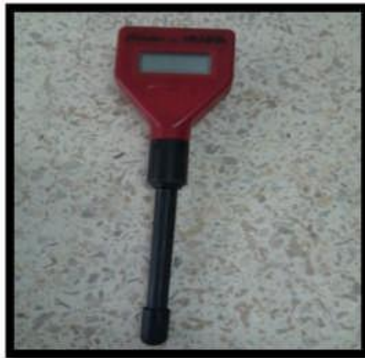
Figure III.10. PH mètre (manuel) (laboratoire du département d'hydraulique université de Tlemcen).
