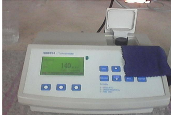
Figure III.11. Turbidimètre (laboratoire du département d'hydraulique université de Tlemcen).
