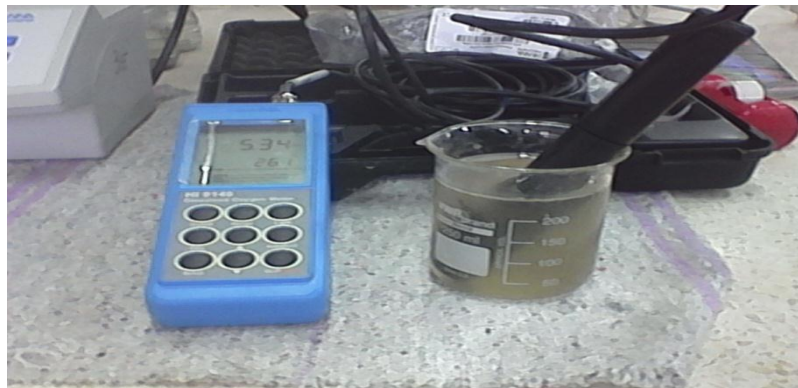
Figure III.12. Oxymètre (laboratoire du département d'hydraulique université de Tlemcen).
