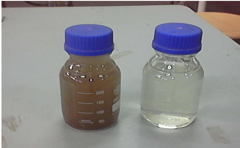
Figure IV.74. Eau à l'entrée du lit bactérien au garnissage de brique silico-calcaire et la sortie du décanteur.
