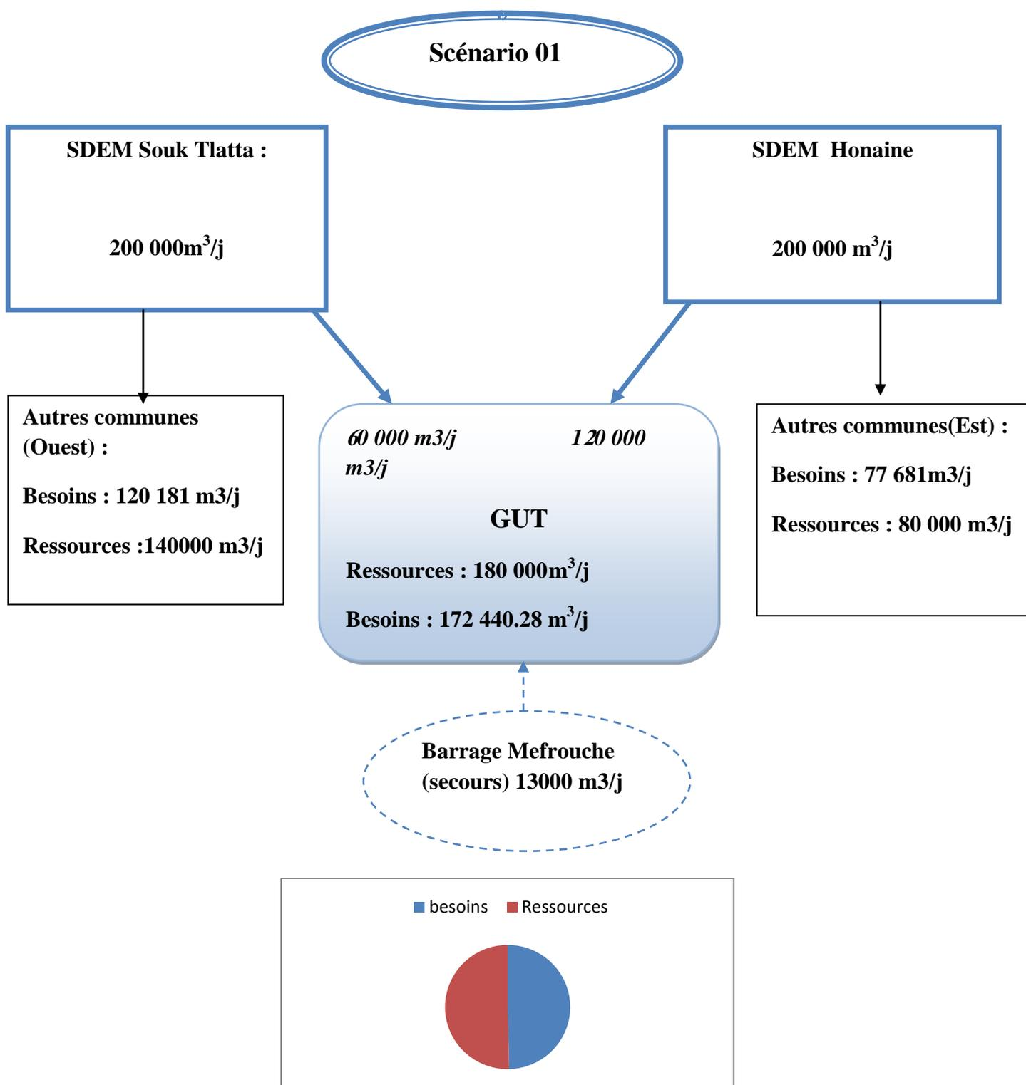
Figure III.9 : Schéma d'optimisation des ressources en eau dans le futur à l'horizon 2050 (scénario 1)
