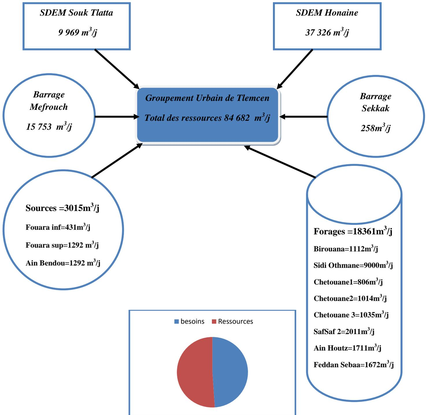
Figure II.13 : Schéma actuel d'utilisation des ressources en eau dans le GUT 2015
