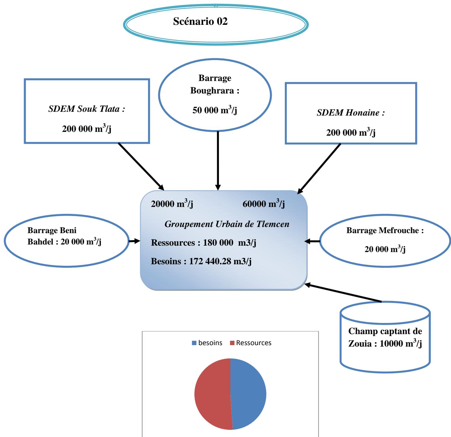
Figure III.12 : Schéma d'optimisation des ressources en eau dans le futur à l'horizon 2050 (scénario 02)
