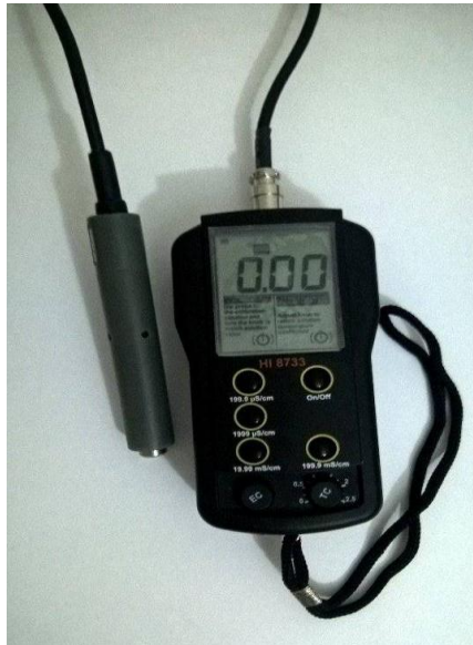
Figure IV. 5: Photo de conductimètre (laboratoire de TEE du Département d'Hydraulique, université Abou Bakr Belkaid Tlemcen).
