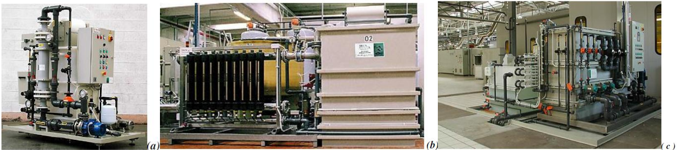
Figure II.2 : Photos de trois unités d'UF différentes : (a)- Unité d'UF avec des membranes céramiques, (b)- Unité d'UF avec des membranes spiralées, (c)- Unité d'UF avec des membranes tubulaires.
