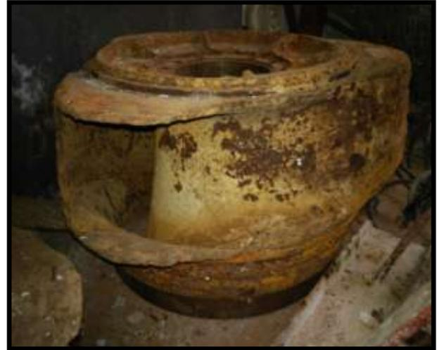
*Figure II.24 : L'érosion des roues.*
