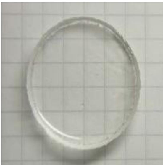
**Figure II.3 :** Photographie d'un réseau de polyABu réticulé à 0.5% de HDDA après l'étape de polymérisation.
