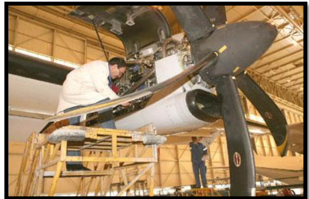
Figure78 : Maintenance d'un moteur d'avion type ATR
