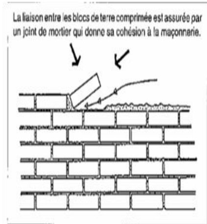
Photo 78 : Rôle du mortier dans un mur en BTC
