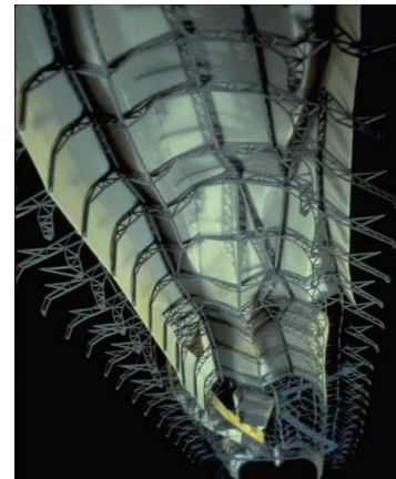
Figure 54 Maquette présentant la structure du terminal
