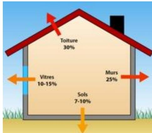
Figure 27 :Déperditions de chaleur .Source : [http://isolation.comprendrechoisir.com/comprendre/isolation\\_thermique](http://isolation.comprendrechoisir.com/comprendre/isolation_thermique) . (Dernier accès le 18/12/2015)
