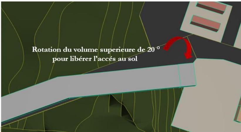
L'accessibilité aux activités étant barrée par la voie mécanique, il est nécessaire d'effectuer la rotation d'une partie du volume pour permettre l'accès à partir du sol par l'intermédiaire d'une culée.
