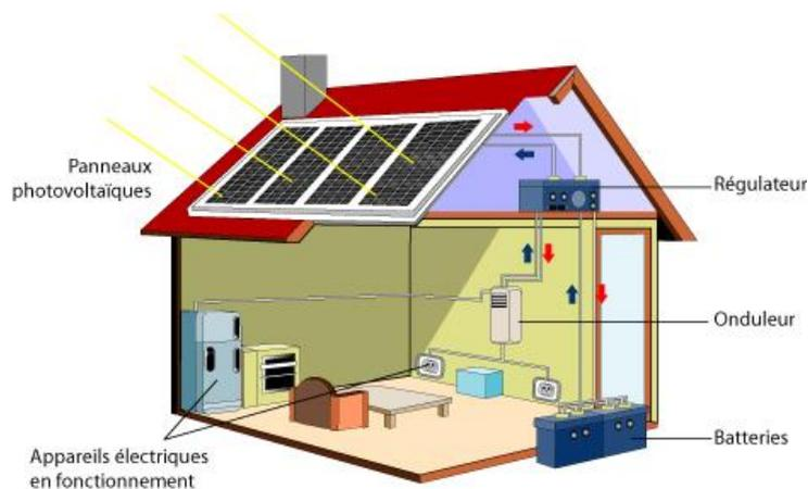
Figure 33 : composants d'un système photovoltaïque intégré au bâtiment .Source : [http://solterre.net/web\\_images/image\\_site\\_isol\\_.jpg](http://solterre.net/web_images/image_site_isol_.jpg) (dernier accès le 25/12/2015) .
