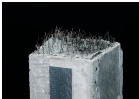
Figure 89 : Béton fibré haute performance.Source : Béton fibré à ultra hautes performances ,produit et applications , Holcim (Suisse )SA,page6
