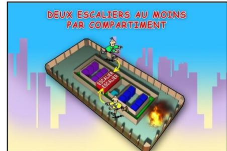
Figure 31 : schéma des nombres des escaliers par compartiments
