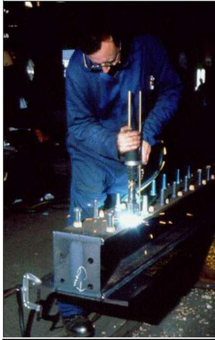
**Figure 31** : Soudure des connecteurs de cisaillement (goujons à tête)
