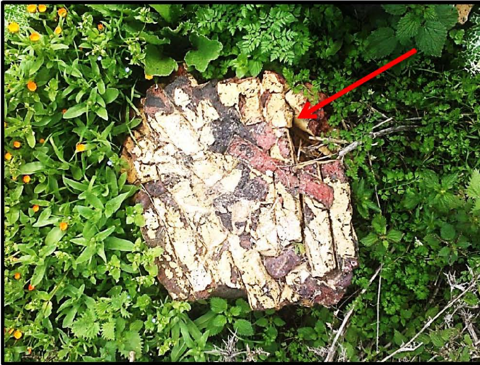
صورة رقم ( 2 ): تبين كتلة من الأجر غير مكتمل الحرق متلاصق مع بعضه البعض
