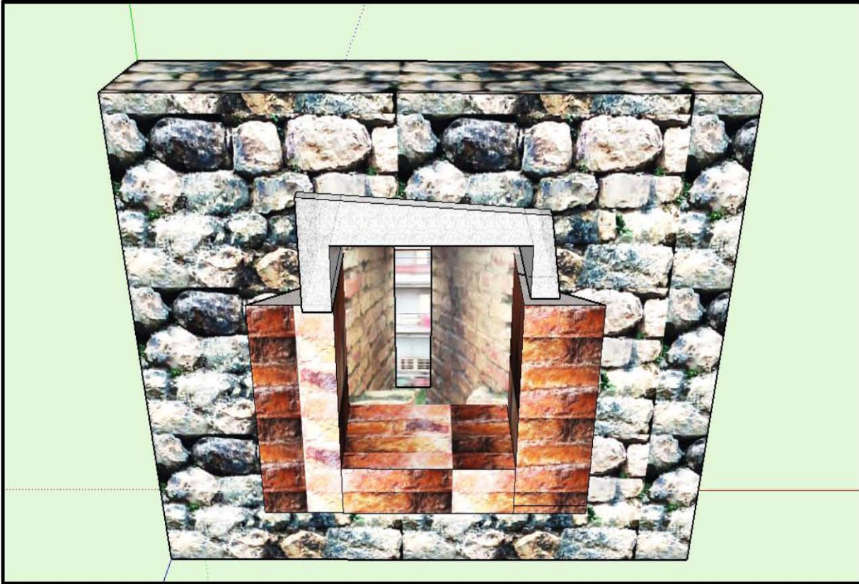
شكل رقم (6): شكل ثلاث الأبعاد يوضح طريقة بناء مزاحل السور البيزنطي بقصبة ميلة
