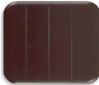
Figure I.24 : Cellule en silicium amorphe
