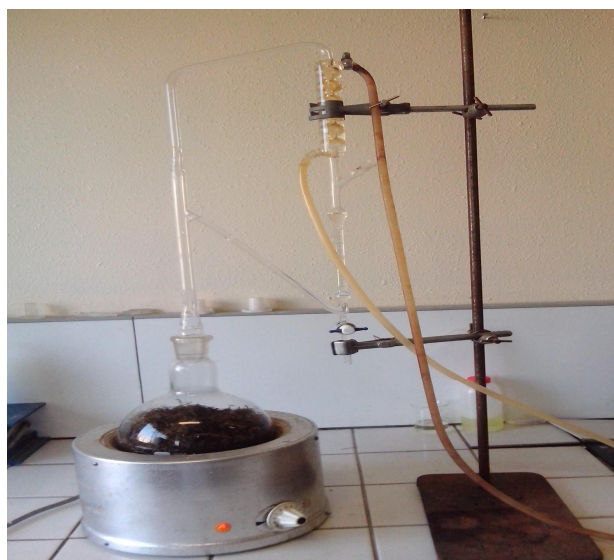
Fig. 8 : Montage de type Clevenger pour l'extraction des huiles essentielles.
