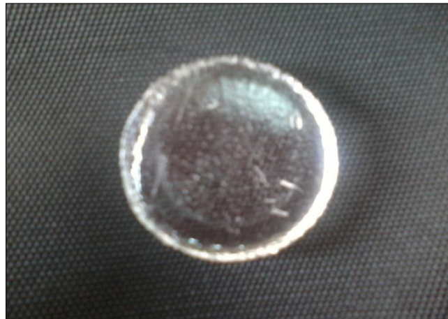
Figure III.5: Réseau de polymère synthétisé par photo-polymérisation (pastille)
