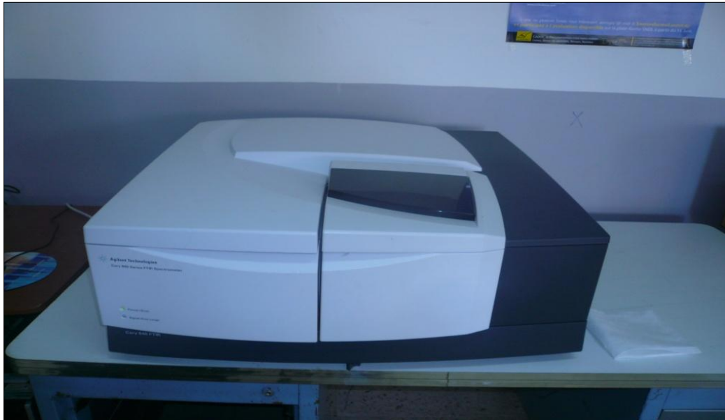
Figure II.2: Spectroscopie Infrarouge à Transformée de Fourier (FTIR) relié à un ordinateur
