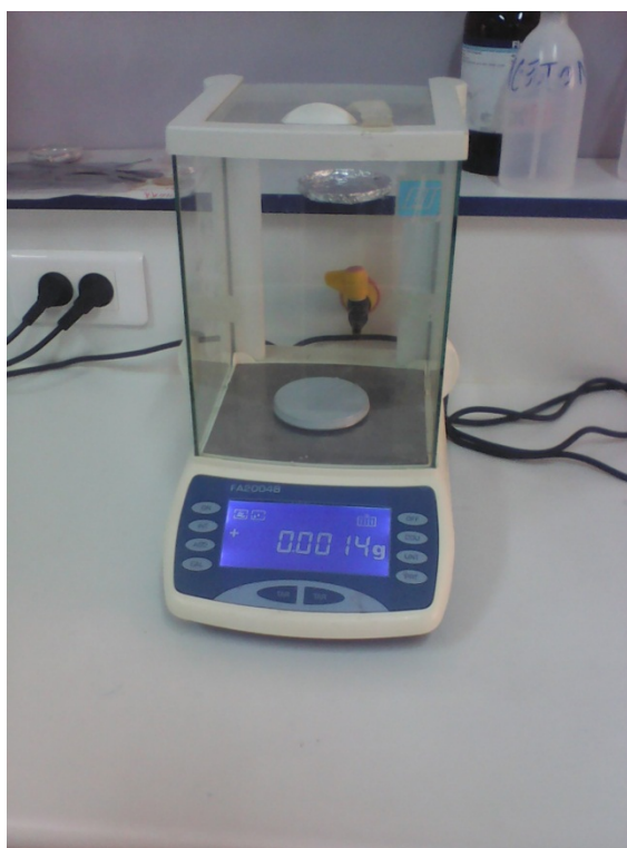
Figure II.12 : Balance utilisée pour l'étude du gonflement
