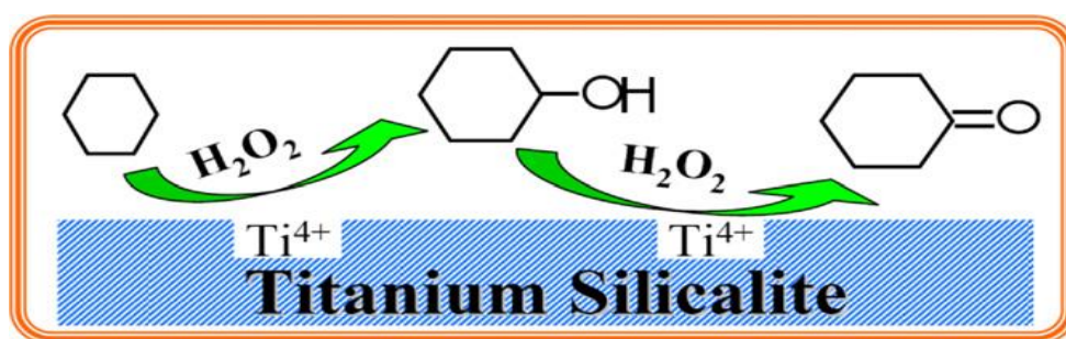
Figure IV.26. Mécanisme réactionnel simplifié proposé pour l'oxydation du cyclohexane sur HTS en présence de \text{H}_2\text{O}_2 comme oxydant [127]
