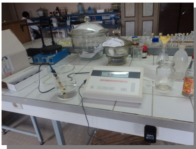
الصورة رقم: 137 توضح طريقة قياس نسبة الحموضة في مياه الأمطار.
