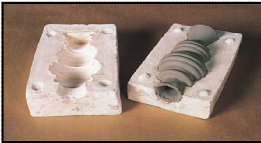
الصورة 03: صورة تبيّن طريقة تشكيل الفخار باستعمال القالب. نقلا عن: Arabic Encyclopédie
