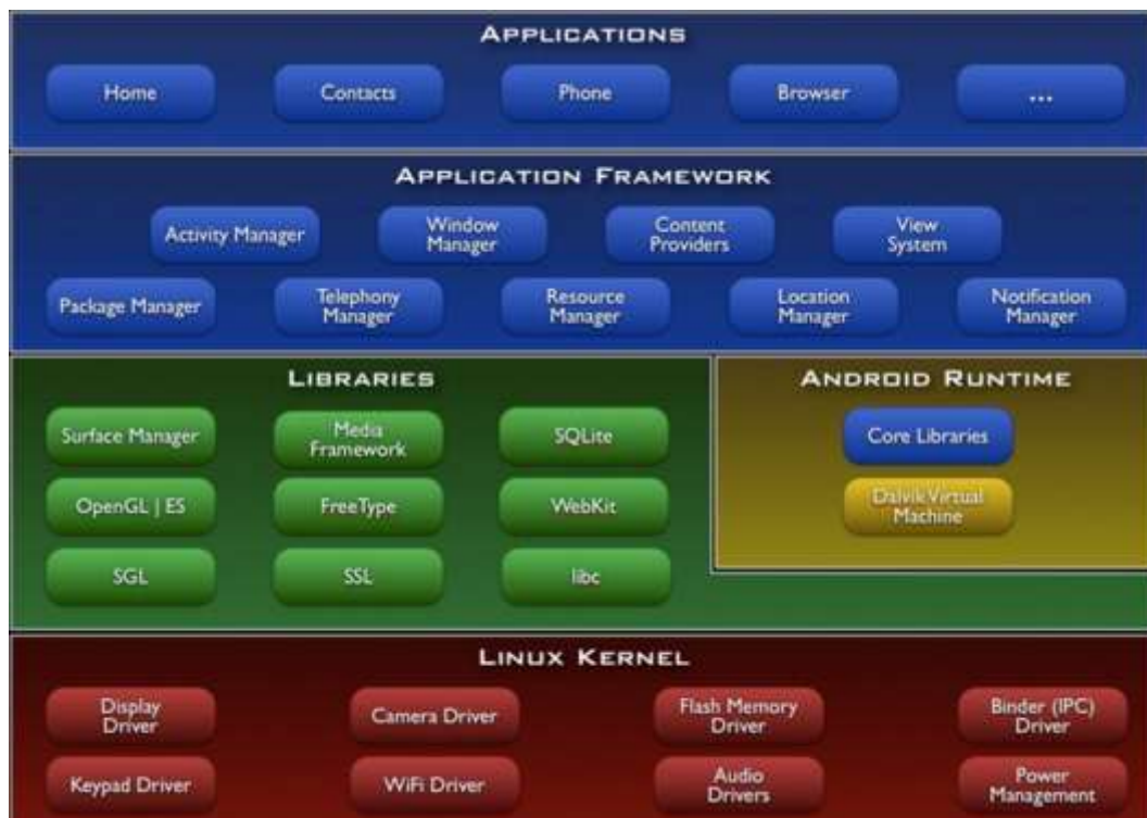
Figure 1 : Les principaux composants du système d'exploitation android
