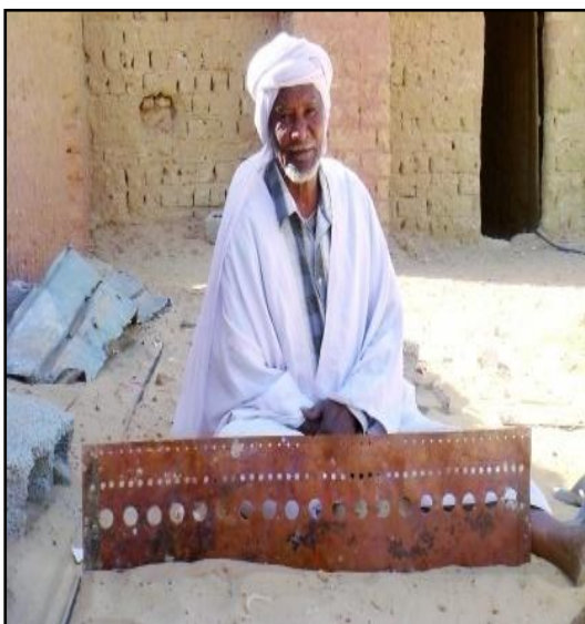
Photo : l'outil de La mesure de l'eau (chegfa) et l'expert de la mesure "kiyal el ma"(Hadje fateh et Rouas, 2011).
