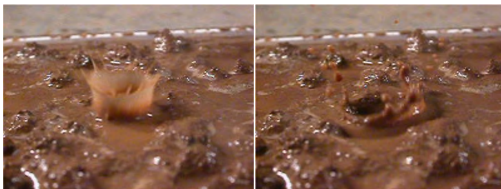
Figure n°9 : Rejaillissement du sol et de l'eau suite à l'impact d'une goutte d'eau ou effet splash (Photos : Pierre-Olivier Cochard, in Leguedois, 2003)
