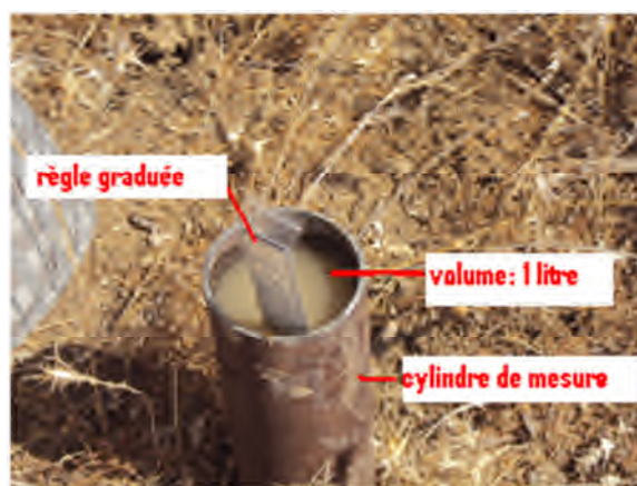
Figure n°23 : test d'infiltration au monocylindre ; matériel facile à transporter nécessitant une faible quantité d'eau par rapport aux simulateurs de pluie
