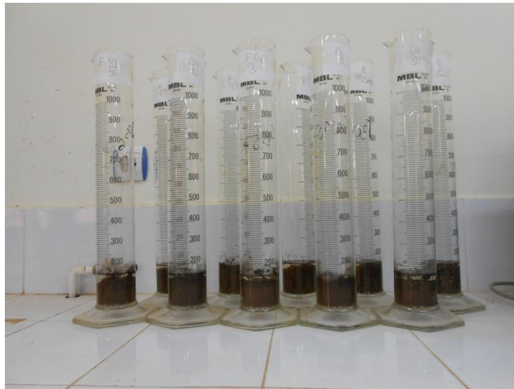
Figure 2.9: Mesure de Perméabilité. Photos prise par Dahmani, (2015).
