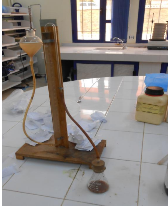
Figure 2.8: Mesure de carbonates de calcium par le calcimètre de Bernard. Photos prise par Dahmani, (2015).
