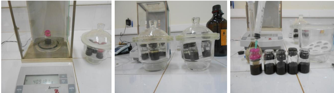
Figure 2.11: Mesure de la Densité réelle. Photos prise par Dahmani, (2015).
