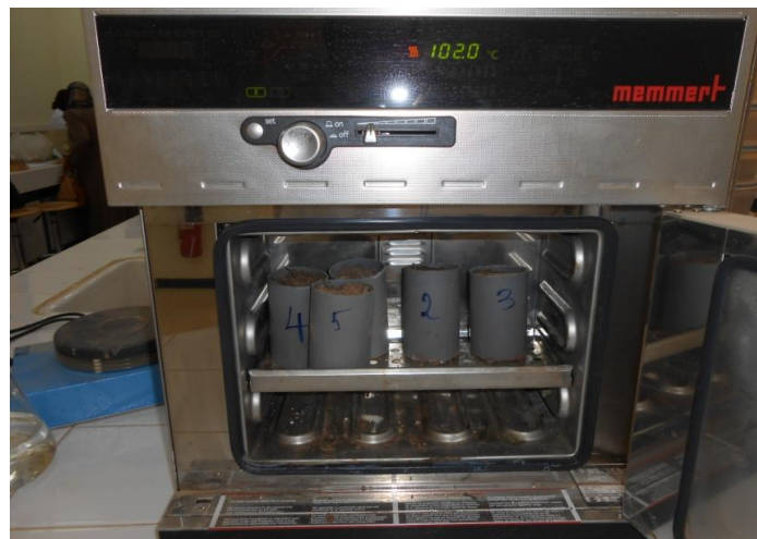
Figure 2.10: Mesure de la densité apparente. Photos prise par Dahmani, (2015).
