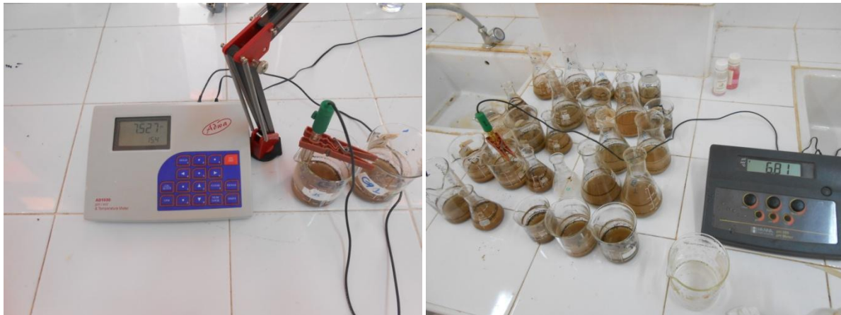
Figure 2.7: Mesure de pH et conductivité de sol. Photos prise par Dahmani, (2015).
