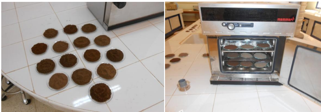
Figure 2.6 : Le sol dans une étuve « Mesure d'humidité gravimétrique ». Photos prise par Dahmani, (2015).
