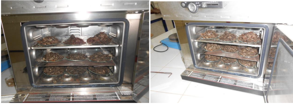
Figure 2.12: Mesure de la Teneur en eau de la litière. Photos prise par Dahmani, (2015).
