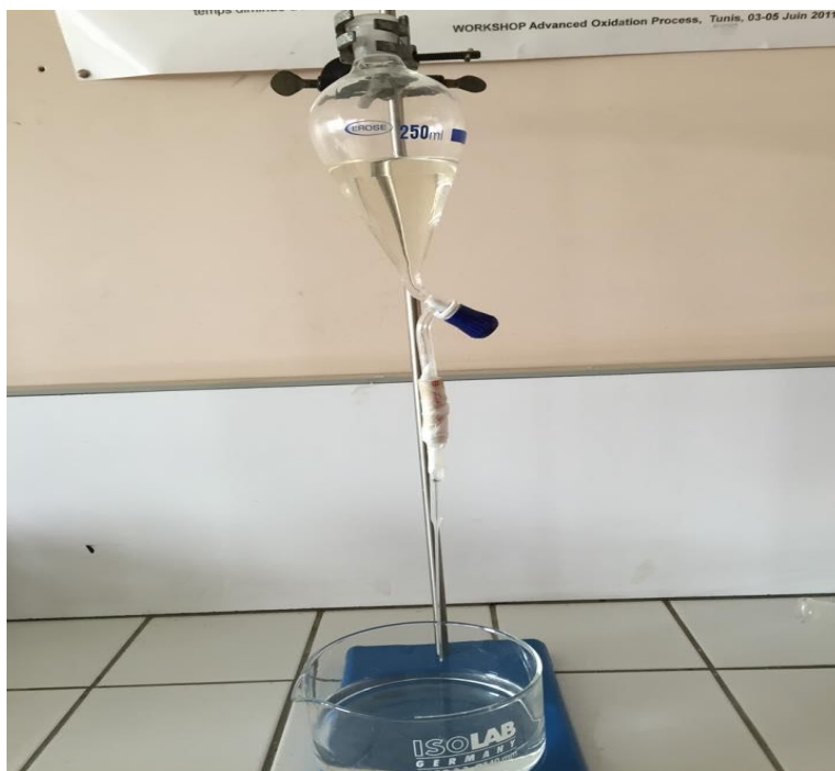
Figure IV.1: Système de précipitation de la solution d'alginate dans la solution de chlorure de calcium
