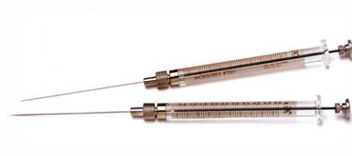
Figure 14 : Image représentant la microseringue d'injection en GC/FID et GC/MS.
