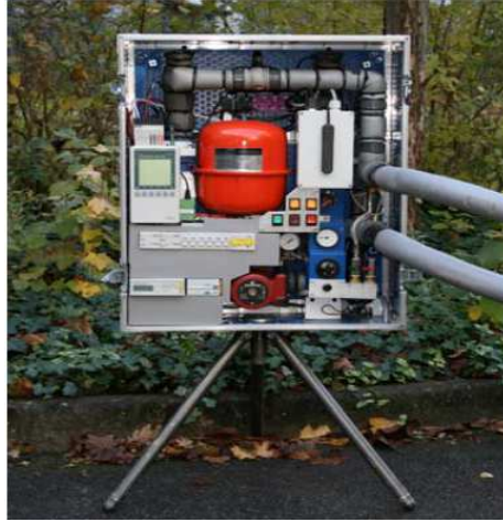
Figure II.1 : Le mini-module de chauffage de l'EPLF.
