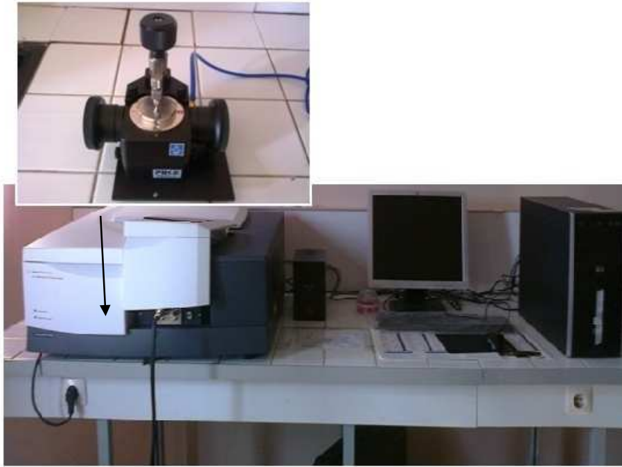
Figure 7 : (a) Dispositifs ATR (Réflexion Totale Atténuée), et (b) Image du spectromètre Infrarouge à Transformée de Fourier (IRTF).
