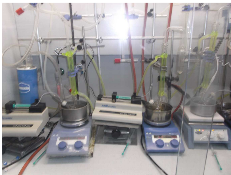
Figure 15 : Montage de la réaction d'époxydation du cyclohexène en phase liquide.
