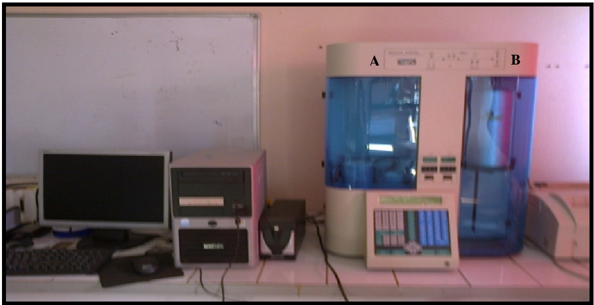
Figure 14 : L'appareil NOVA 1000° utilisé pour les mesures BET.
