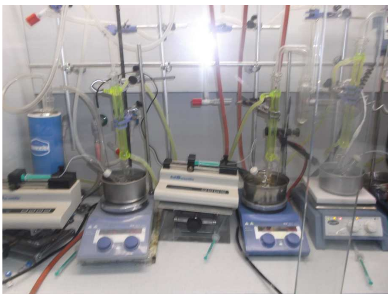
Figure 1 : Montage de la réaction d'époxydation du cyclohexène en phase liquide
