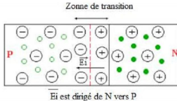
Figure II.2 : Schéma descriptif d'une jonction PN en équilibre thermodynamique.
