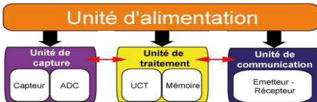
Figure 1. 1 : Architecture d'un capteur sans fil [1].
